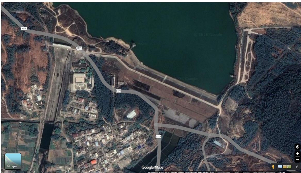
图1 六蓝水库事件前工程布置及东坝头附近通道的卫星影像。右侧可见东坝头附近的坝肩外旁路式开敞通道；公开报道将其与自溃式非常溢洪设施联系起来，但其正式功能、控制高程及与早期缺口的关系仍需设计资料和调查核定。图片来源：Google Maps（影像来源见图中标注）。
